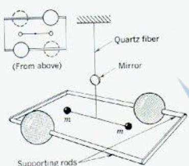
جادبهای وارد می شود، این امر باعث چرخیدن دمبل و در نتیجه تاب خوردن رشته نازک و چرخش آینه می شود. با استفاده از شیشه مدرج می توان میزان انحراف آینه ( $\alpha$ ) را هنگام چرخش گلوله های کوچک اندازه گیری نمود.
