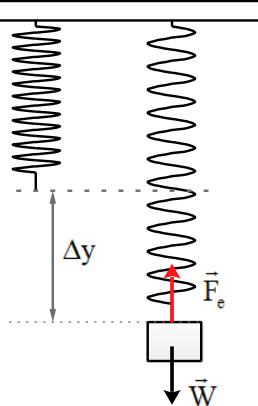
(الف) تعدادی فنر با ضخامت‌های مختلف تهیه می‌کنیم. هر چه فنر انعطاف‌پذیر تر باشد. سختی (K) کوچکتر و برای فنر سفت (K) بیشتر است.
