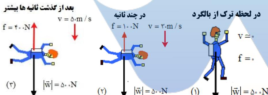
پس از مدتی مقاومت هوا با وزن چتر باز برابر شده و نیروی خالص وارد بر چتر باز صفر می‌شود و چتر باز با تندری ثابتی به طرف زمین حرکت می‌کند.
